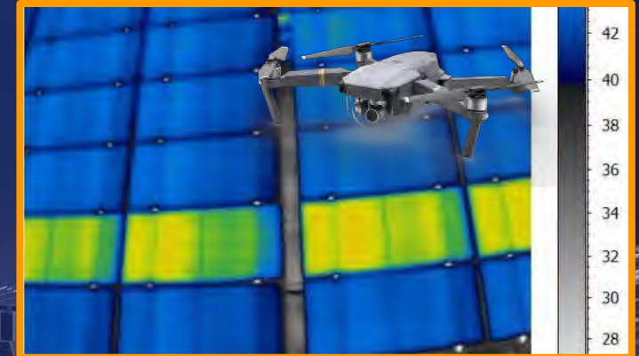
Thermografie mit Drohne
